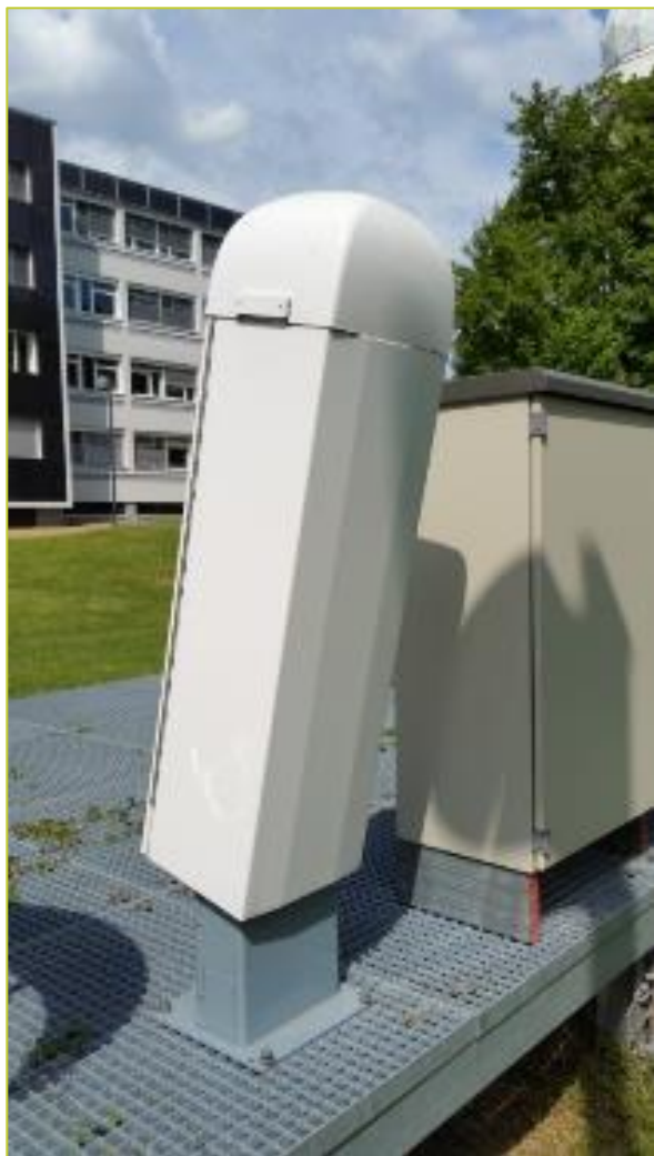
Abbildung 25: Vaisala Ceilometer CL51 im Messgarten der ZAMG
